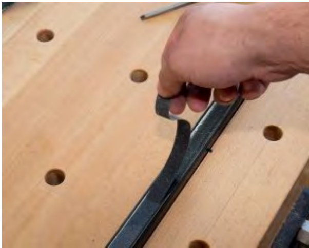
Das alte Schleifpapier wird entfernt.
